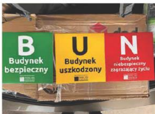
Fot. 16. Naklejki zaprojektowane przez PIIB do oznaczania ocenianych budynków, tuż po wystąpieniu powodzi we wrześniu 2024 roku
